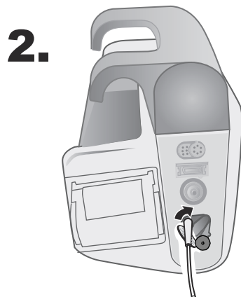
Abbildung 9-1 Anschließen des Messleitungsanschlusses am CO 2 -Einlass
