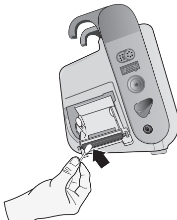
Abbildung 25-3. Reinigen des Druckkopfs
