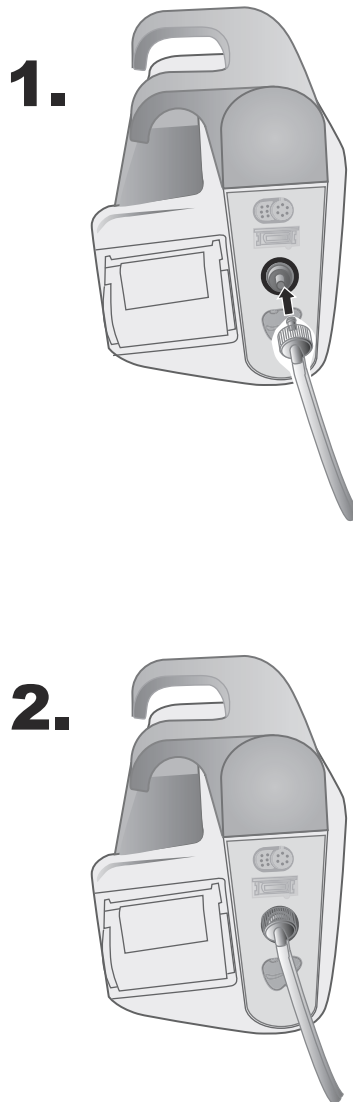
Abbildung 8-1 Anbringen eines Doppellumenschlauchs am X Series Gerät
